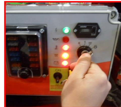
Afbeelding 5: fase voor verwarming bougies motor.
