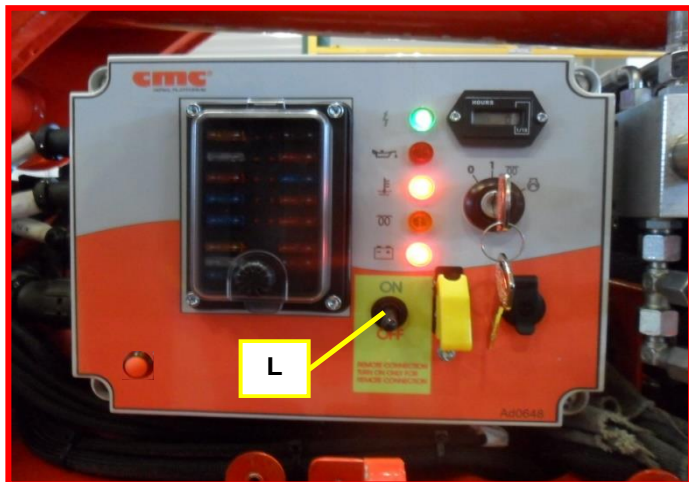
Afbeelding 115: kastje start/stop op het onderstel.
