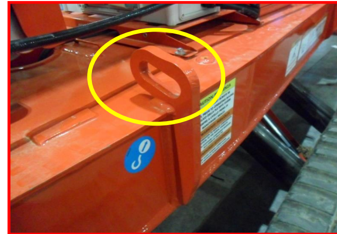
Afbeelding 41: bevestigingspunten op het onderstel.
