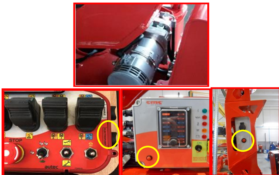
Afbeelding 62: activering elektrische pomp (*optioneel).
