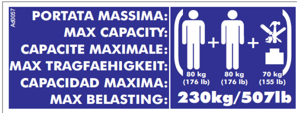
Afbeelding 70: maximaal toelaatbare belasting korf.
