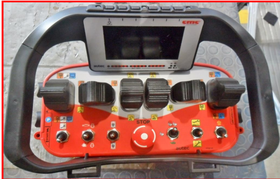
Afbeelding 13: bedieningspost AUTECH-afstandsbediening platform.
