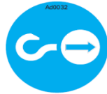
Afbeelding 90: aanduiding bevestigingspunten voor brugkraan.
